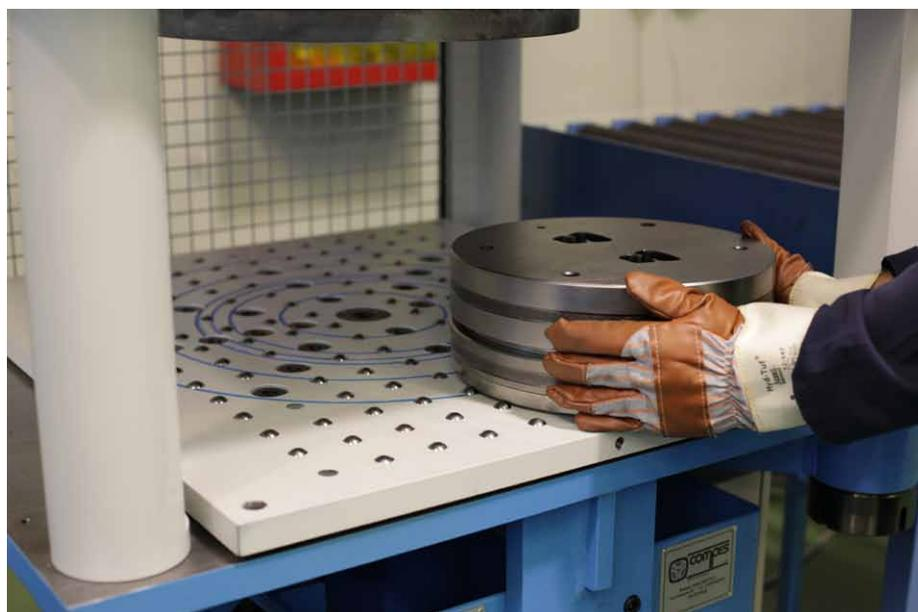
Die DCM - DIE COUPLING MACHINE® erlaubt den Zusammenbau von Platte und Dorn, gleichzeitig mit Beseitigung der störenden Geräuschbelastung verursacht von Arbeiten mit dem Hammer.
