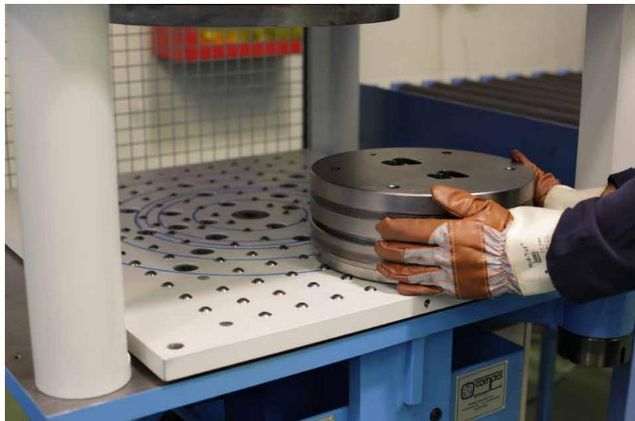
La DCM - DIE COUPLING MACHINE® permet d'assembler plaquette et aiguille, en éliminant la désagréable pollution acoustique typique du travail avec marteau.
