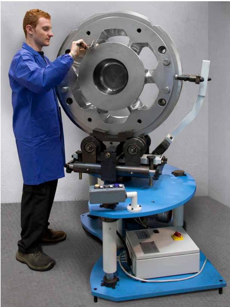
DCS - DIE CORRECTOR STATION® ist von Compes entwickelt worden, um den Anforderungen der Korrektoren von Matrizen für Aluminium Strangpressen entgegenzutreten: die Sicherheits-Schwierigkeiten beim Festhalten, Bearbeiten und Berichten von Matrizen für Strangpressverfahren zu beseitigen, die mit dem normalerweise erhöhten Gewicht und Durchmesser in Verbindung stehen.
