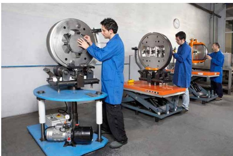
Die DCS 650 und DCS 1200 ermöglichen Werkzeuge zu halten, arbeiten und korrigieren in angemessener und technologischer Weise, im Vergleich zu selbstgebauten Geräten mit keinem Sicherheitssystem oder dem traditionellen Schraubstock der in Verbindung mit einem Hebezeug zu Verwendung kommt, um die fallenden Teile zu vermeiden.
