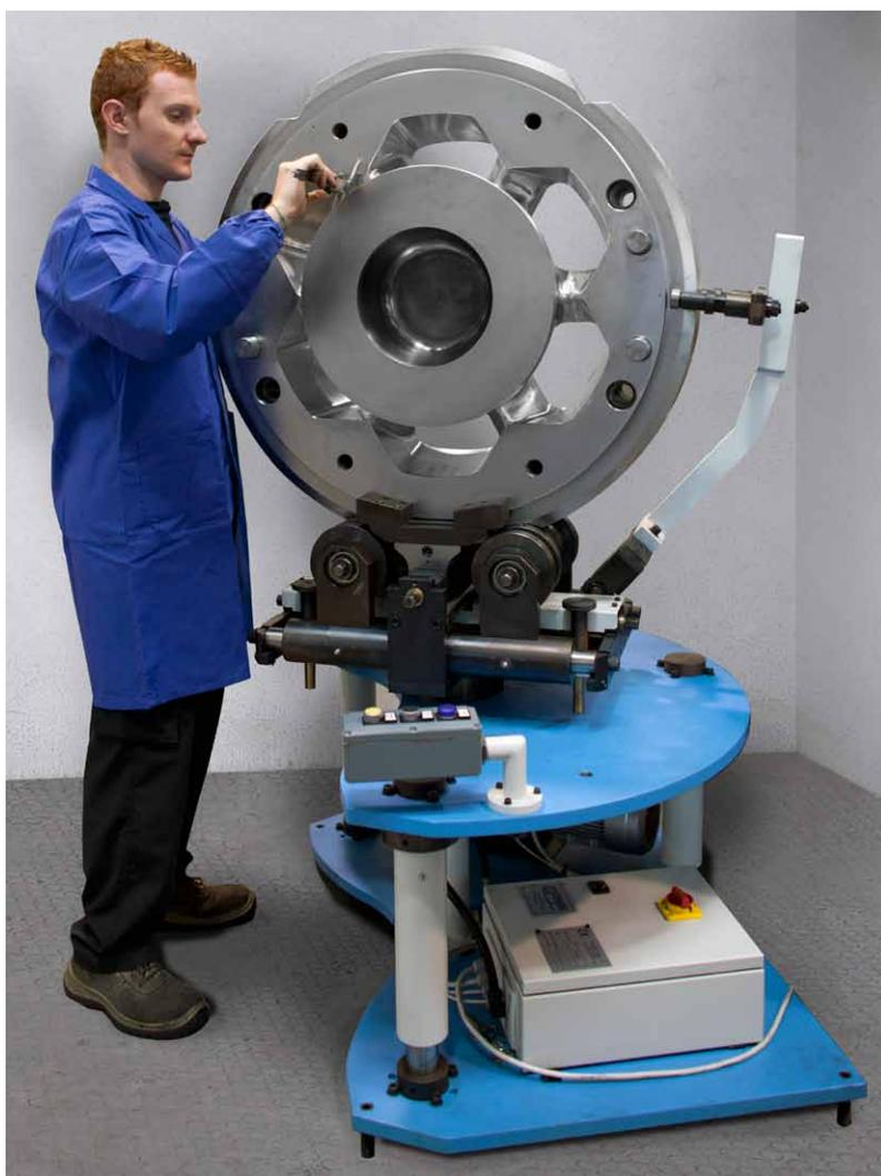
La DCS - DIE CORRECTOR STATION® ha sido diseñada y producida por Compes para satisfacer las necesidades de los correctores de matrices para extrusión de aluminio: retener, trabajar y corregir la matriz y eliminar los problemas de seguridad relacionados con el peso y el diámetro, lo que facilita el movimiento en las distintas etapas de corrección.
