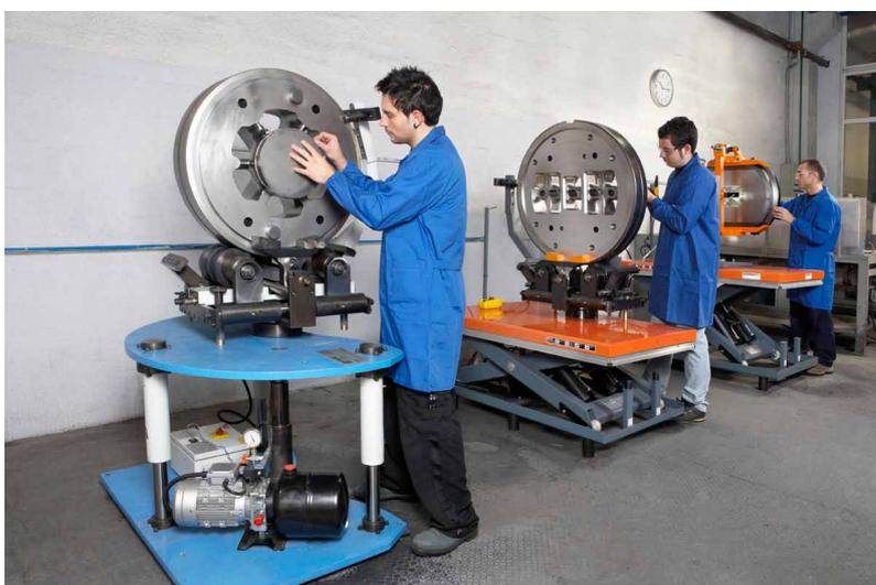
La DCS 1200 permet de retenir, travailler et régler les filières d'une façon plus technologique par rapport aux équipements produits à l'intérieur sans aucun système de sécurité ou à l'étau traditionnel qui doit être utilisé avec un palan pour éviter la chute des pièces.
