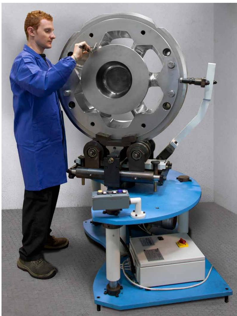
La station de travail DCS - DIE CORRECTOR STATION® a été projetée et produite par Compes pour aller au-devant des désirs des correcteurs de filières pour extrusion aluminium : retenir, travailler et régler les filières en éliminant les problèmes de sécurité liés au poids et au diamètre, en facilitant beaucoup le mouvement dans les plusieurs phases de correction.
