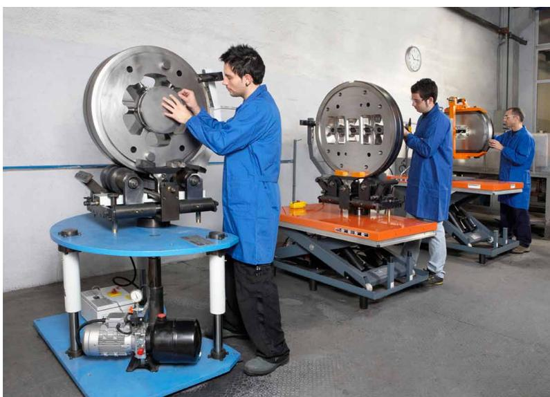
La DCS 650 e DCS 1200 consentono di trattenere, lavorare e correggere matrici in modo più consono e tecnologico rispetto ad attrezzature autocostruite prive di ogni sistema di sicurezza o alla morsa tradizionale che deve essere utilizzata congiuntamente ad un paranco per evitare la caduta dei pezzi.
