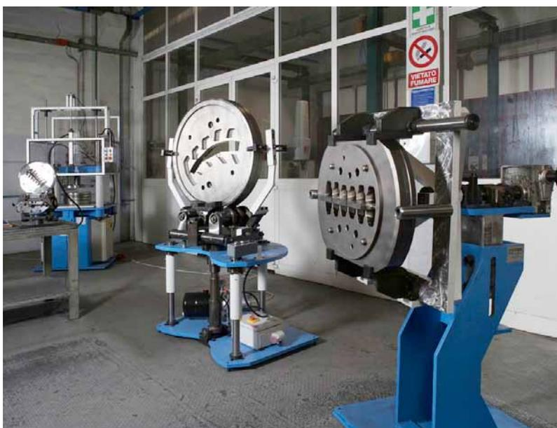
DCS 650 и DCS 1200 позволяют удерживать матрицу и работать с ней в более приемлемой и технологически совершенной манере, по сравнению с самодельным инструментом, где отсутствует какая-либо система безопасности, или по сравнению с традиционными тисками, которые нужно использовать вместе с талью, чтобы избежать падения матрицы. Автоматическая система позволяет легко работать с матрицей, производить контроль и коррекцию, которые могут быть необходимы перед или после экструзии:
